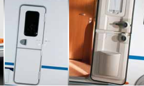
Neue Eingangstüren (höher und breiter mit Abfallbehälter und Moskitonetz)
